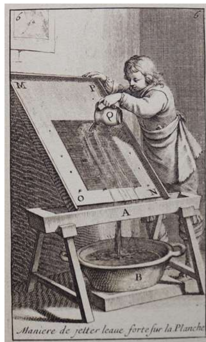
Manière de verser l'acide sur la plaque (A. Bosse 1645)
